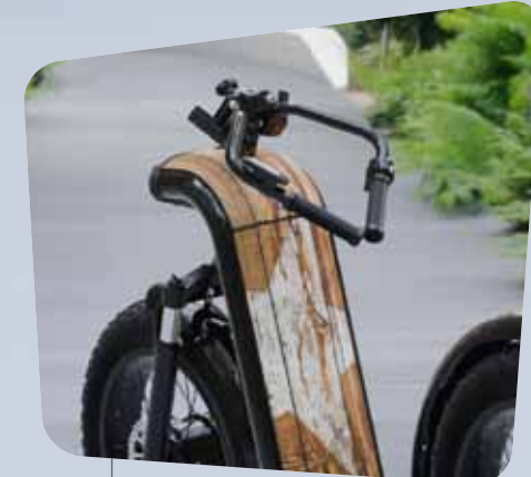
Guidon pliant qui se rabat vers le bas (très pratique pour le rangement dans les soutes de camping car, 98 cm de hauteur une fois le guidon plié.)
