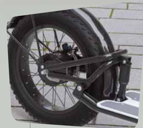
Suspension arrière avec amortisseur à air et grande garde au sol (ultra confortable)
